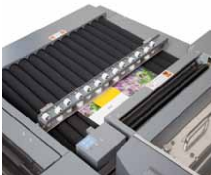
Transportmodul für die 90 Grad Bogenübergabe vor oder nach dem integrierten Falzmodul Duplo IFS.
