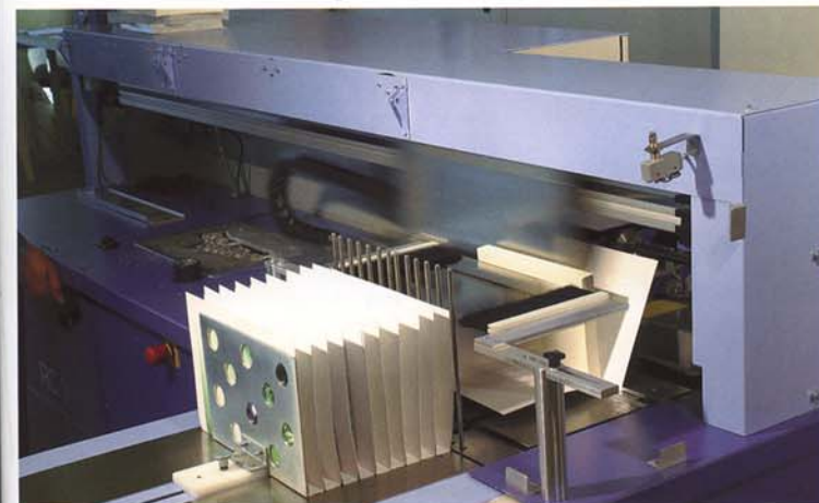
Der Kaltleim Klebebinder DiBiTech RC 1 ist für mittlere Auflagen gedacht und wird in drei Varianten angeboten.
