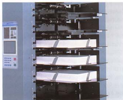
Infrarot-Detektoren minimieren die Fehlerquote.
